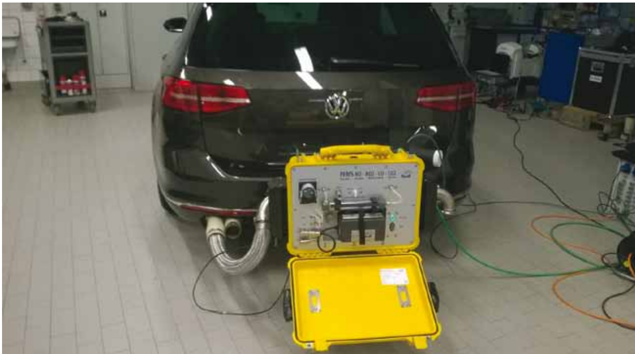
Fahrzeug bei der Einrüstung einer PEMS-Anlage
