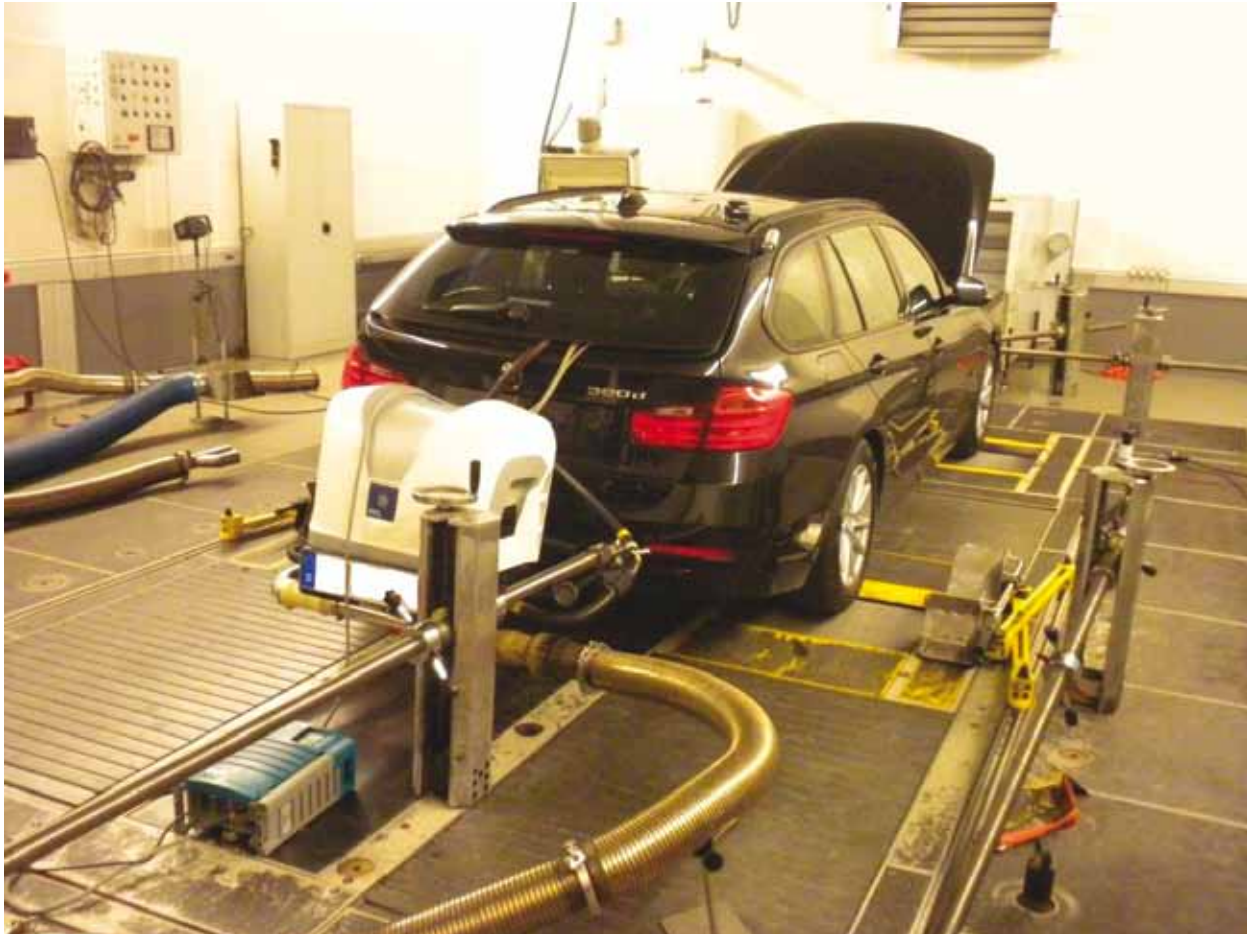
Validierung der PEMS-Anlage auf dem Rollenprüfstand
