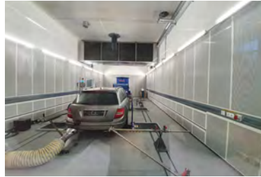
Auf einem solchen Rollenprüfstand werden standardisierte Fahrzyklen unter reproduzierbaren Randbedingungen (Lufttemperatur, Fahrprofil, Lasten) durchgeführt.
