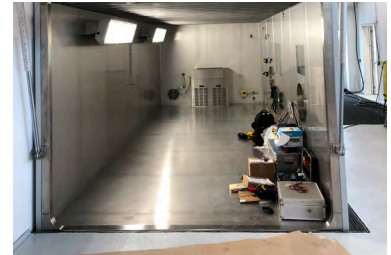
Aufbau eines Containers zur Messung von Verdunstungsemissionen (SHED)
