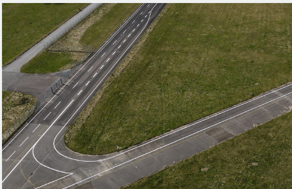
Fahrbahnmarkierung des Autobahnbereichs der auf dem Testgelände in Leck befindlichen Teststrecke (Quelle: KBA)
