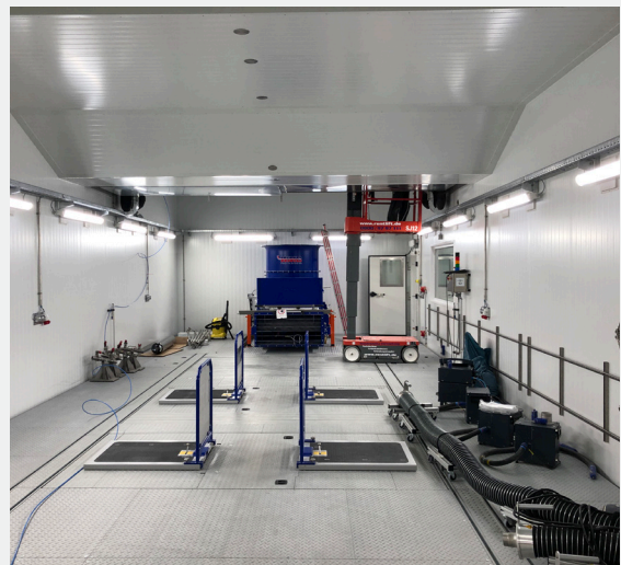
Klimatisierter Rollenprüfstand zur Durchführung von unterschiedlichen Prüfscenarien (Quelle: KBA)
