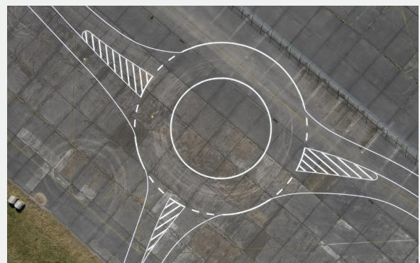
Fahrbahnmarkierung eines Kreisverkehrs zur Prüfung kritischer Fahrsituationen in städtischen Umgebungen (Quelle: KBA)
