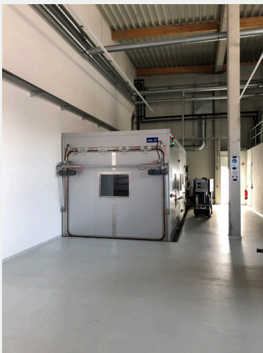
Versiegelter Raum zur Prüfung der Verdunstungsemissionen (engl. SHED) (Quelle: KBA)
