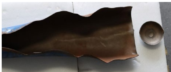
Teile eines geplatzten Gasdruckbehälters
