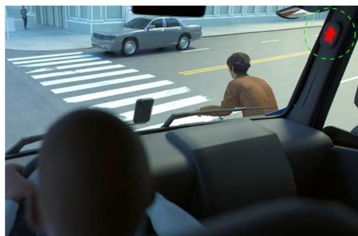
Bild: Montageposition Warnanzeige
