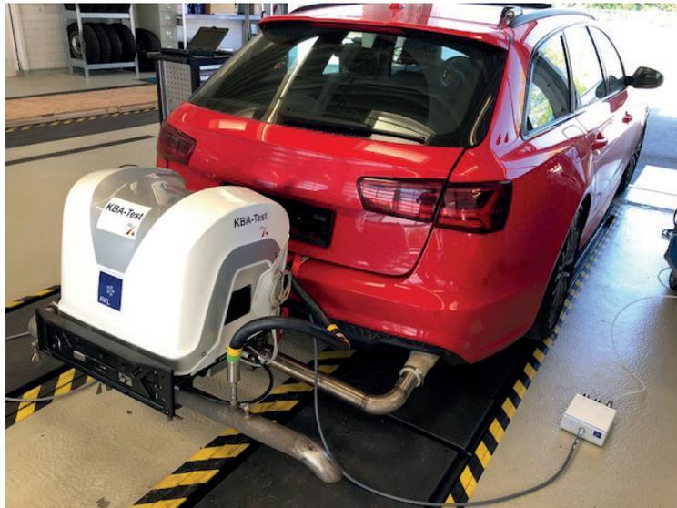
Abbildung 1: Gas PEMS Montage auf Kugelkopfkupplung
